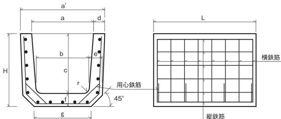
用心鉄筋は呼び600の側溝についてだけ線径6.00mmの普通鉄線又はコンクリート用鉄線を両側にそれぞれ4か所入れる。
