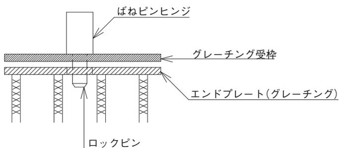
グレーチング開閉時は、ロックピンを押し上げて下さい。
