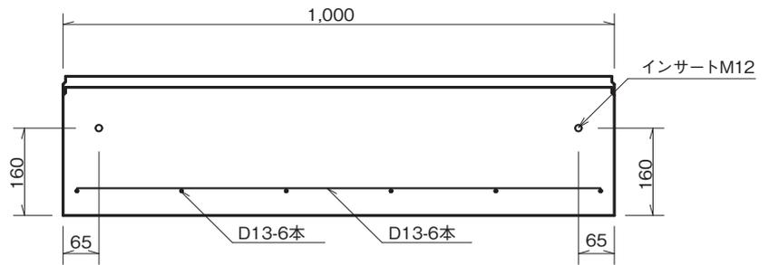
鉄筋コンクリートL形250B 基礎付 異形2~5cm(2) L=600mm T=150mm
